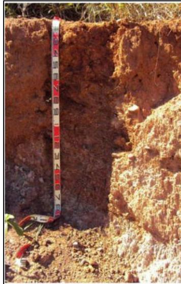
Foto 2.7: Cambissolo Háplico (CX) desenvolvido em relevo suave ondulado e ondulado da região de Pimenta Bueno.
