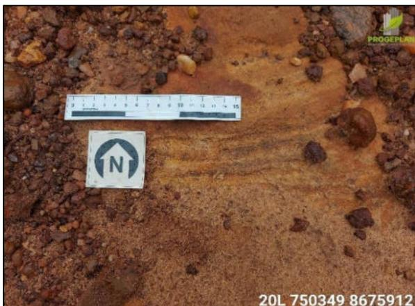
Foto 2.10: Vista do Cambissolo com afloramento e concreções lateríticas.
