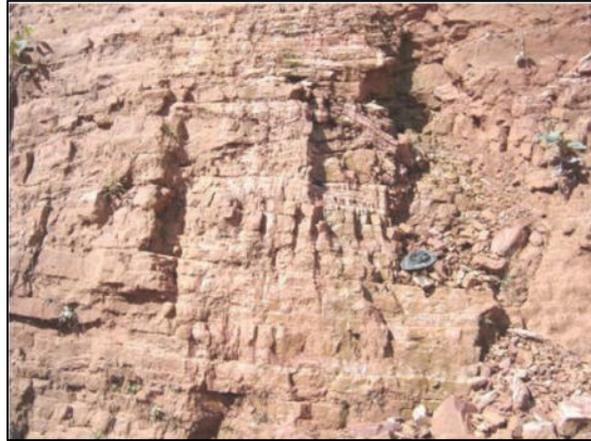
Figura 2.20: Estratificação plano-paralela de arenitos da formação Fazenda Casa Branca, UHE Rondon II.
