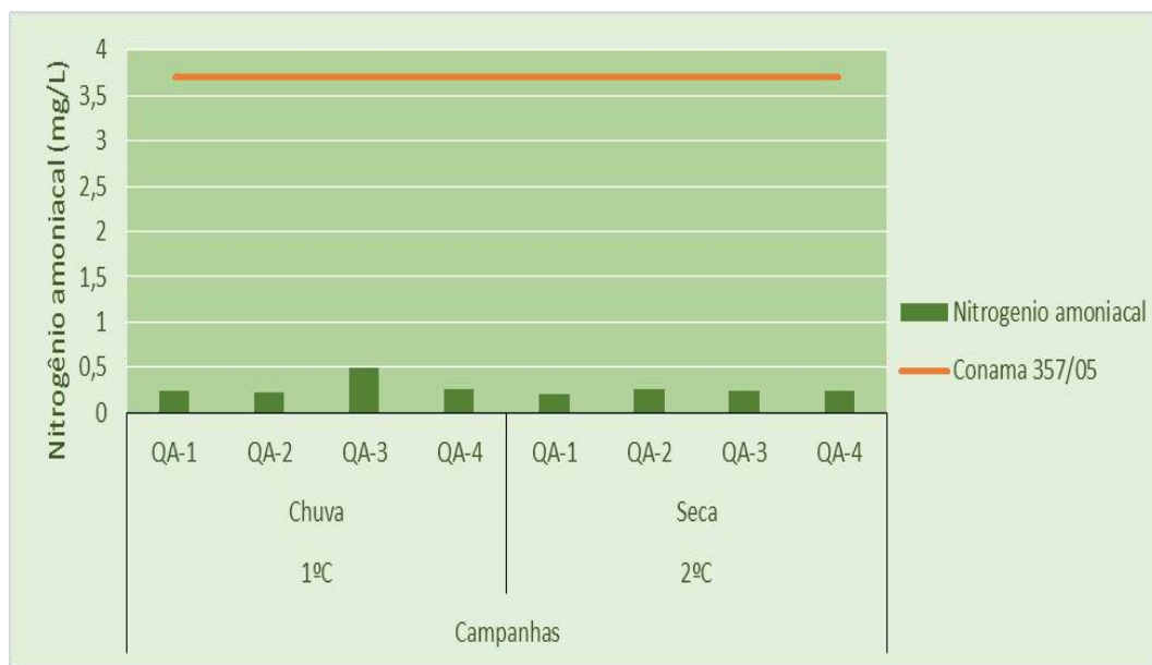
Figura 1.55: Nitrogênio amoniacal registrado nos pontos de amostragem durante o Diagnóstico da Qualidades das Águas Superficiais da PCH Guariroba.
