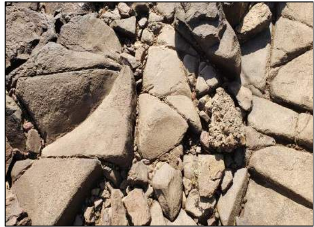
Foto 1.10: Visão de detalhe das fraturas presentes no basalto da Formação Serra Geral.
